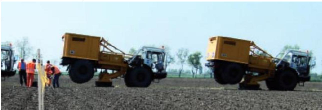
Figura 2.1-4: Vibroseis - Mezzi in attesa, arrivati nella posazione di energizzazione prdefinita, la ruote posteriori alzate permettono una migliore coesione a terra della piastra che sarà poi messa in vibrazione da un sistema elettro-idraulico. [Foto DGSUNMIG].
