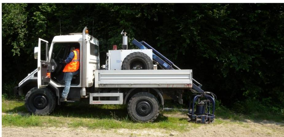
Figura 2.1-5: Mini-Vibroseis usato singolarmente per operazioni geofiche più limitate. La piastra vibrante è alla base della campana premuta a terra dal braccio del mezzo. Il cilindro sopra la piastra ed interno alla gabbia è il dispositivo elettro-idraulico che imprime la vibrazione alla piastra [Foto DGSUNMIG].
