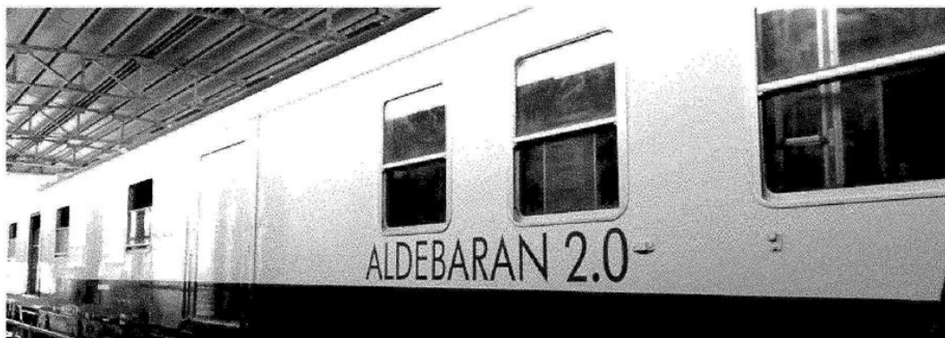
Treno diagnostico. La nuova carrozza Aldebaran 2.0 di Rfi (Fs) avrà il compito di sorvegliare le principali linee convenzionali
