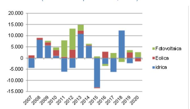
Figura 4-5 - Produzione elettrica su base annua da solare, eolico e idro (var. su anno precedente, GWh)
