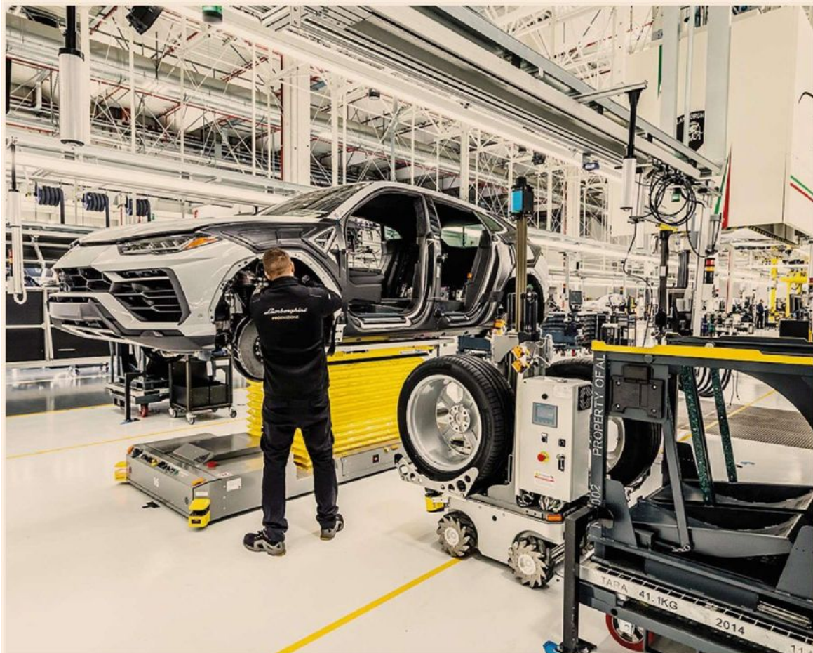
Innovazione. I robot collaborativi che affiancano gli operatori nelle attività di assemblaggio nella fabbrica della Lamborghini Urus, chiamata Manifattura Lamborghini a Sant'Agata Bolognese, uno dei primi esempi in Italia di fabbrica 4.0
