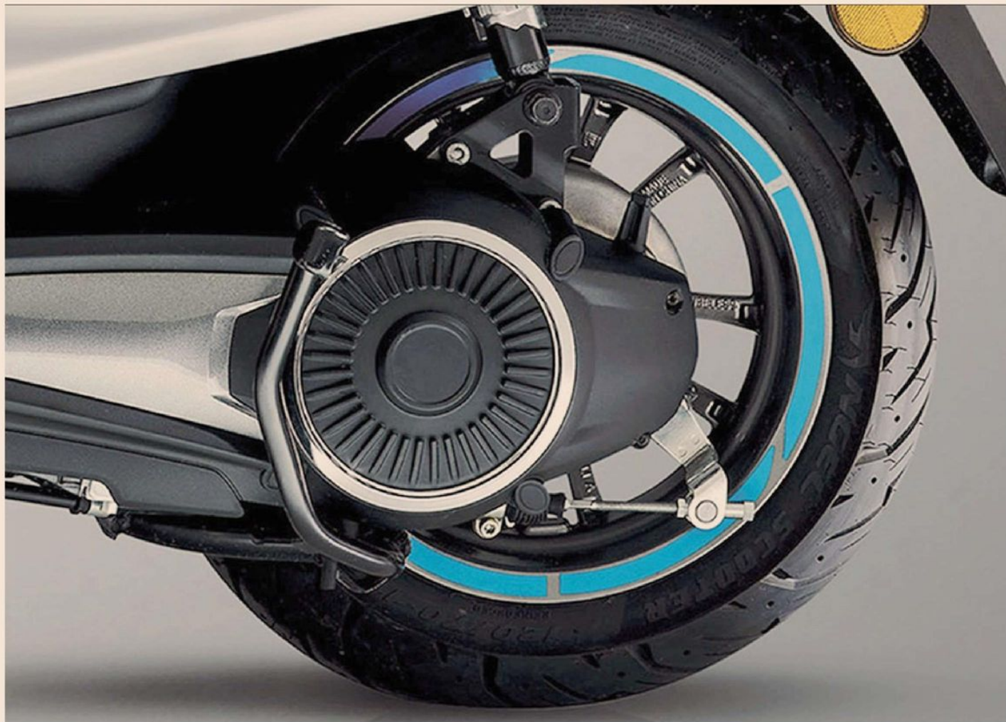
Trend elettrico. I veicoli elettrici rappresentano il futuro del trasporto (nella foto: il gruppo motopropulsore della Vespa Elettrica totalmente made in Italy)
