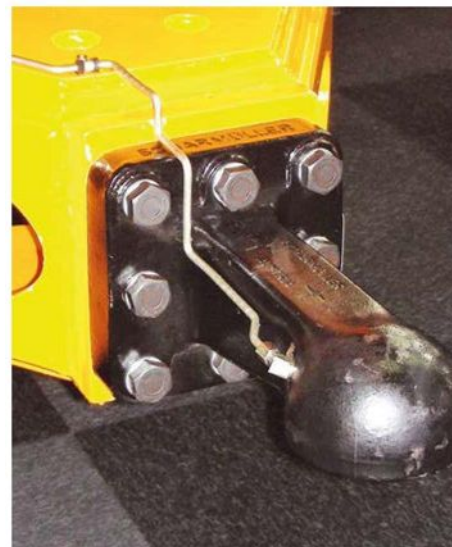
Foto 4 Tra le novità introdotte dal regolamento 167/2013 la possibilità di omologare mezzi a 4 assi e ganci a sfera che per il tipo di progettazione offrono un carico verticale statico massimo ammesso fino a 4.000 kg (omologazione del trattore permettendo)
