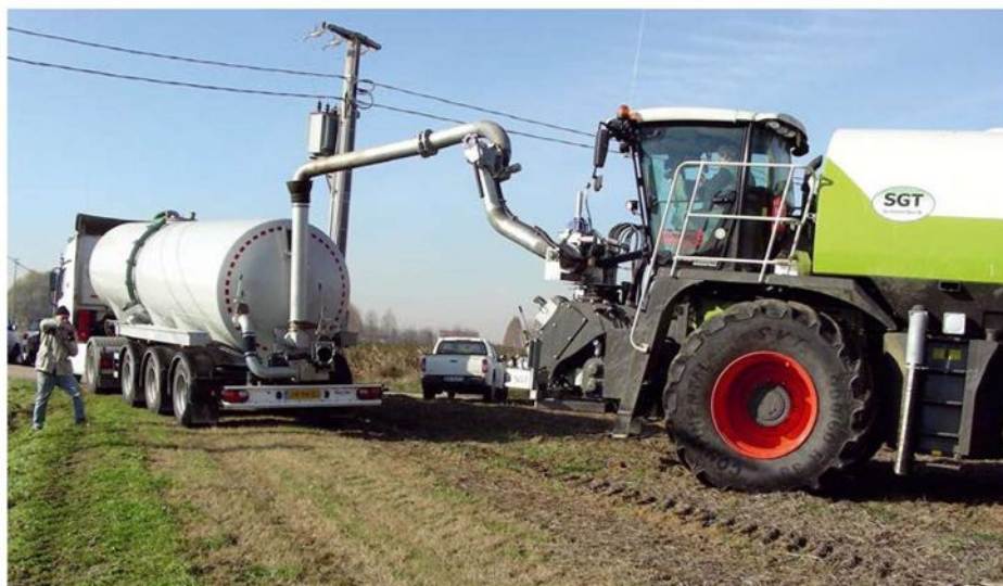
Foto 6 Nell'impiego fuori strada è importante avere una buona ripartizione delle masse sugli assali eliminando per quanto possibile picchi di carico per rispettare il terreno e migliorare il comportamento dinamico del veicolo. A tal scopo oltre al tipo di sospensione, aiutano gli pneumatici larghi a bassa pressione con eventuale telegonfiaggio e la pianificazione dei passaggi in campo atti a minimizzare le corsie di transito (prevedere lo scarico e il carico a bordo campo o l'impiego di rimorchi navetta cingolati tra la raccogliitrice e il mezzo stradale)
