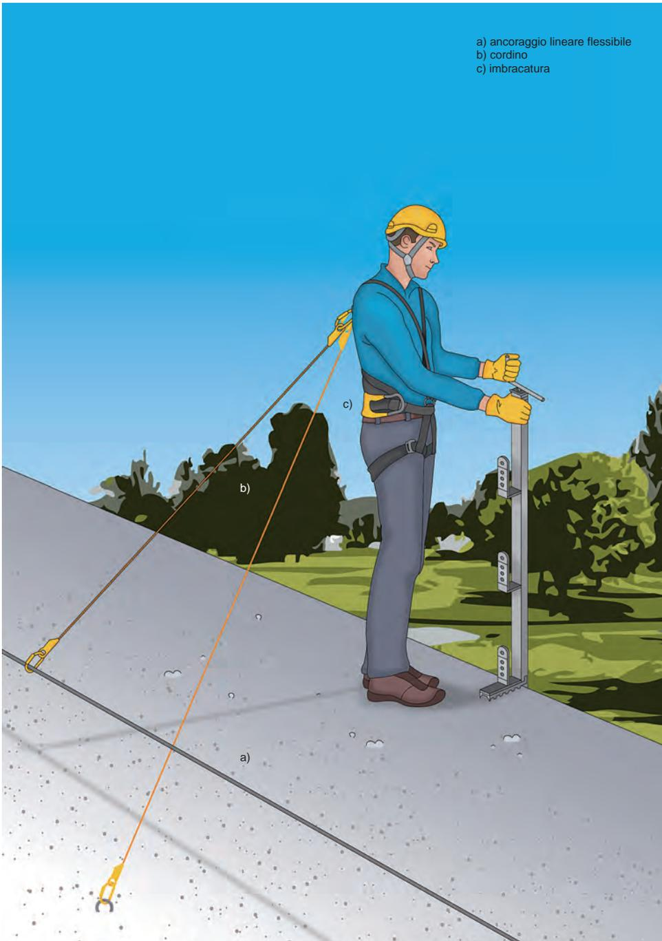
**Figura 1** - Esempio di un sistema di trattenuta
