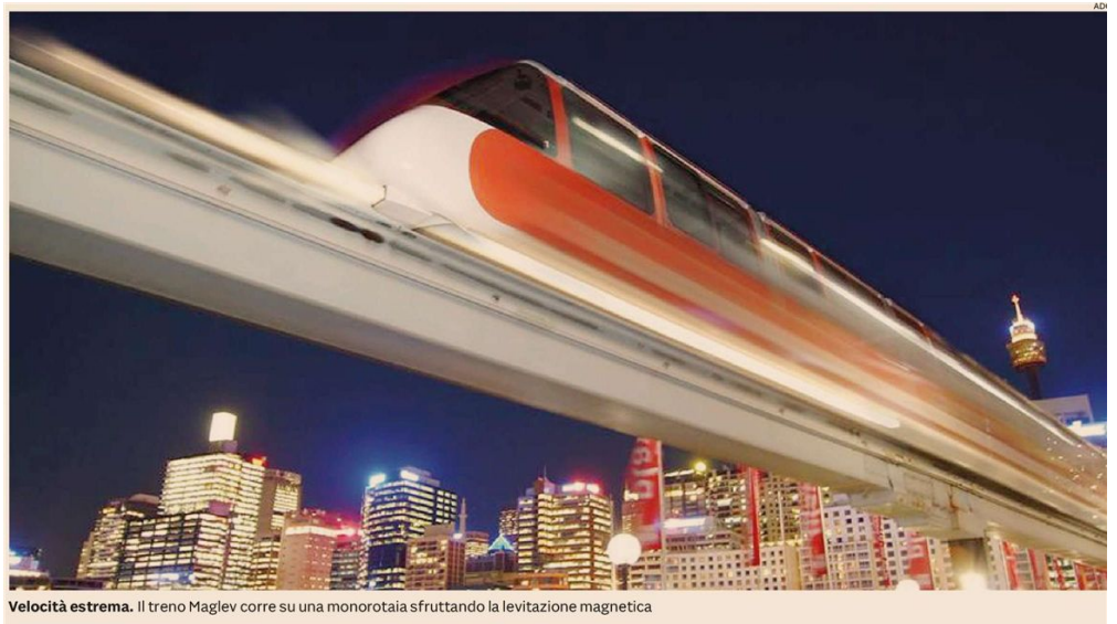
Velocità estrema. Il treno Maglev corre su una monorotaia sfruttando la levitazione magnetica
