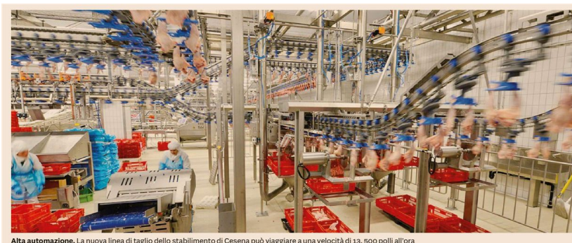
Alta automazione. La nuova linea di taglio dello stabilimento di Cesena può viaggiare a una velocità di 13.500 polli all'ora
