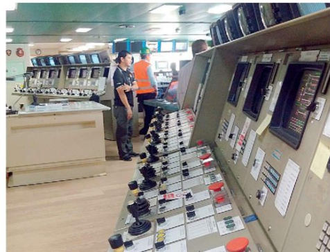
Al largo. La Saipem 7000 durante la posa dei colossali generatori eolici del progetto hywind . Sotto, a sinistra, fervono i lavori sul ponte di coperta della Saipem 7000: sul lato destro, è posata una piccola pala, lunga una quarantina di metri, da installare su un "ventilatore" eolico. Sotto, a destra, il ponte di comando della nave, con in primo piano i quadri di comando delle zavorre
