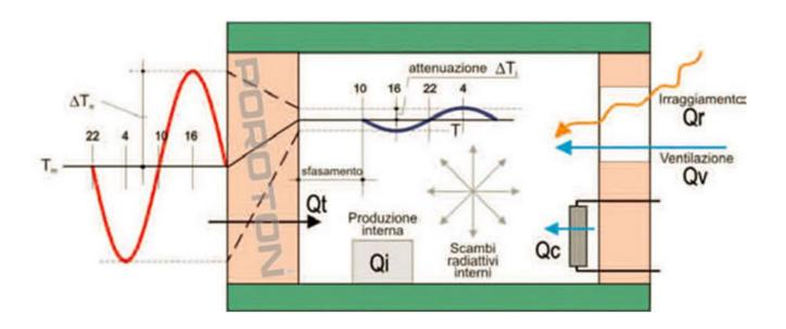
Fig. 1 – Smorzamento e sfasamento dell'onda termica. Pareti dotate di massa superficiale elevata attenuano l'entità dell'escursione termica esterna che si trasmette all'interno (attenuazione) e ne ritardano l'ingresso (sfasamento).
