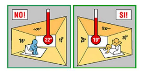
Fig. 2 - Condizione di discomfort (a sx) e di comfort (a dx)
