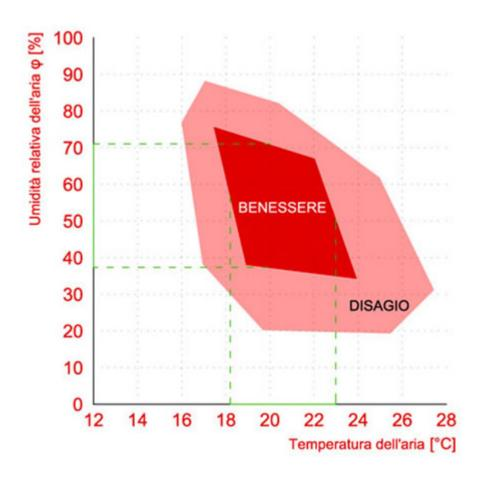
Fig. 3 – Diagramma del benessere termo-igrometrico, con individuazione delle condizioni di comfort e discomfort, in relazione alla temperatura dell'aria (°C) e all'umidità relativa dell'aria (%).
